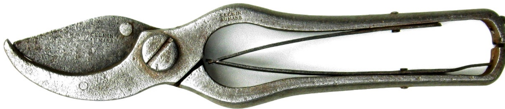
Sécateur estampillé " CHEMIN AU MANS ", ressort à fourchette, longueur 215 mm, poids 601 g
